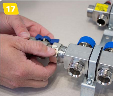
Drehen Sie im nächsten Schritt den Kugelhahn seitlich am Verteilerstamm fest. Der blaue Kugelhahn gehört dabei an den Rücklauf mit den blauen Ventilkappen.
